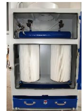
Integrierte Absaugung mit Patronenfilter 0,75 KW mit Staubschublade
