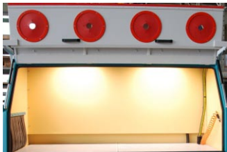
Strahlraum mit Frontklappe Gitterrost, Innenraumbeleuchtung, Strahldüse und Luftausblaspistole
