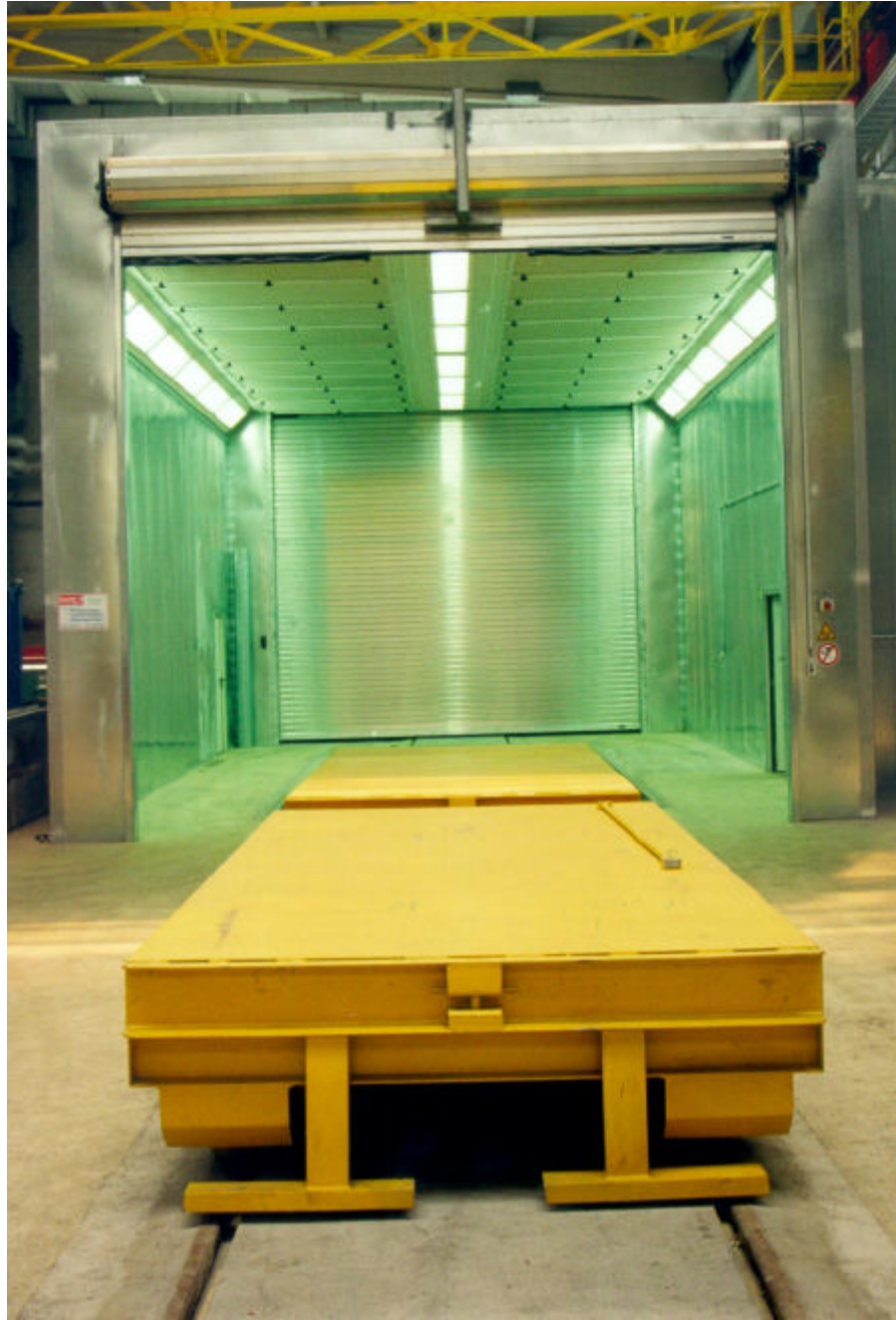
Kombinierte Lackier- und Trockenanlage für Windkraft-Rotoren mit zwei pneumatisch angetriebenen Transportwägen
