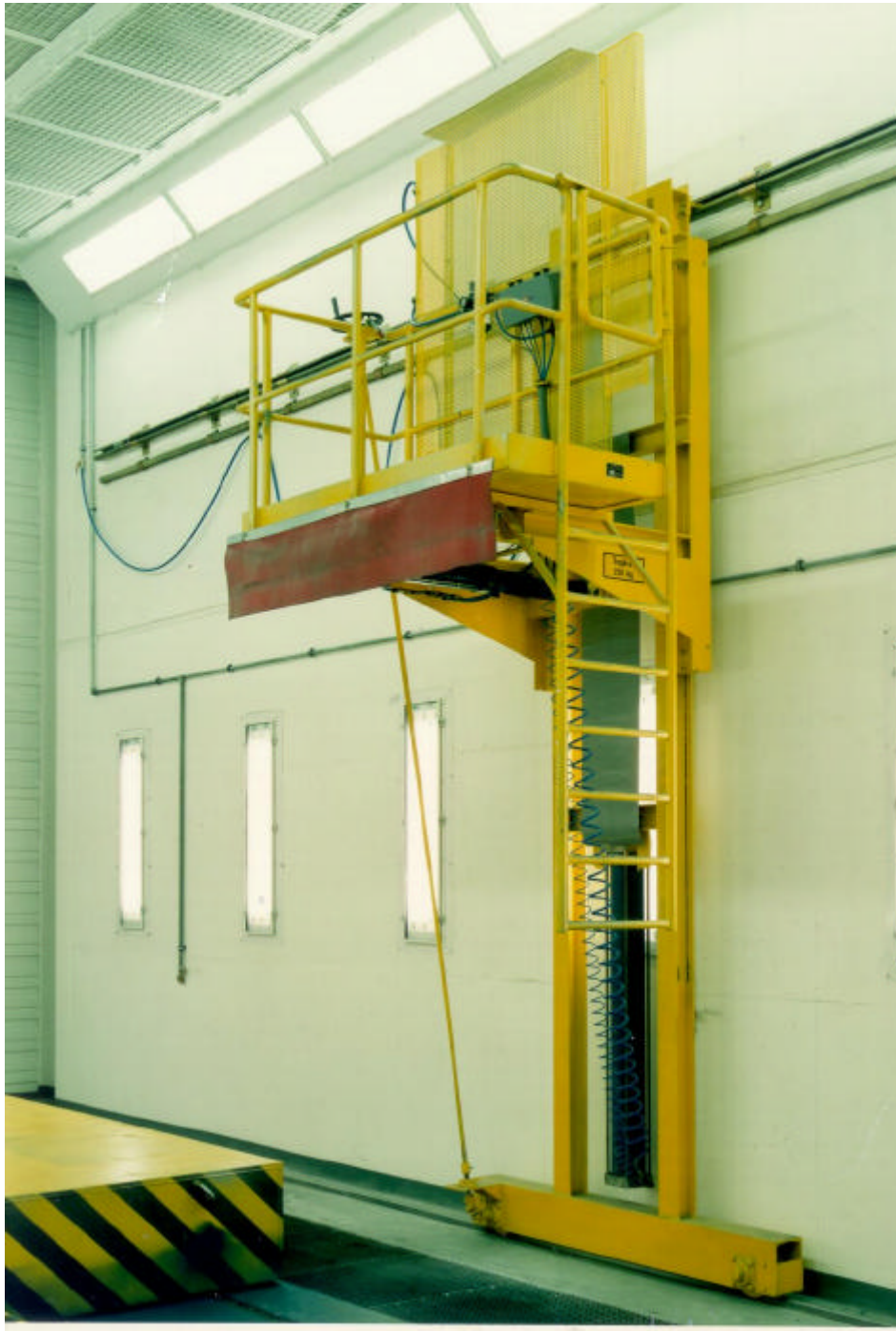
Hubarbeitsbühne für Lackieranlage
