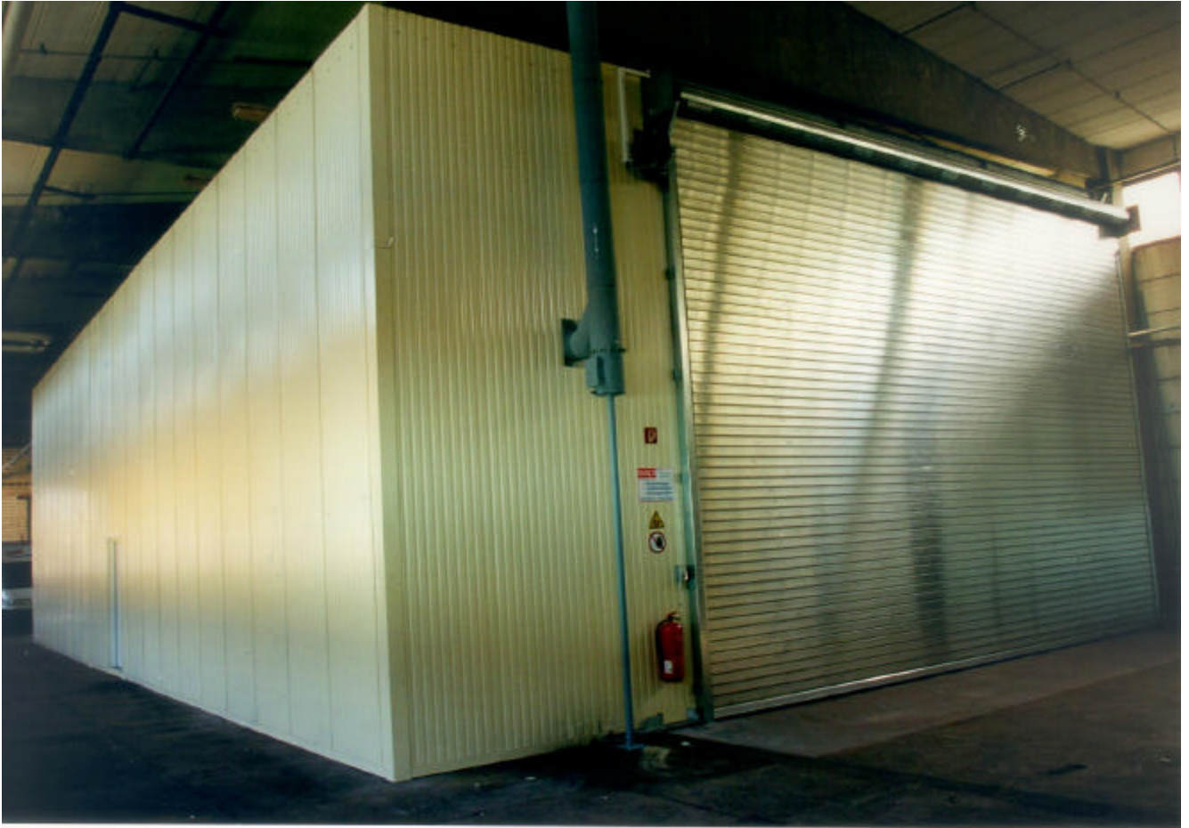
Einhausung kombinierte Lackier- und Trockenanlage
