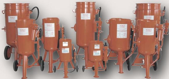
Напорные аппараты SAPI предназначены для работы со всеми стандартными мелкозернистыми абразивами (песок, гранит, корунд, стальная и чугунная дробь, ПВХ-гранулы и др.), и обеспечивают возможность как сухой, так и влажной обработки.
